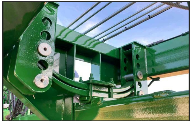
Nastavení výšky táhla příčné pružiny
