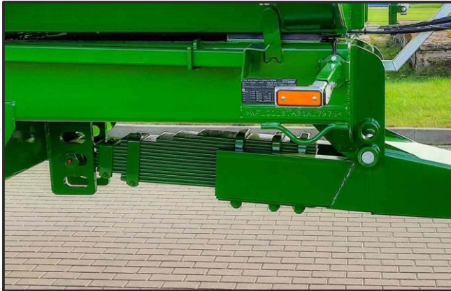
výšky táhla podélné pružiny
